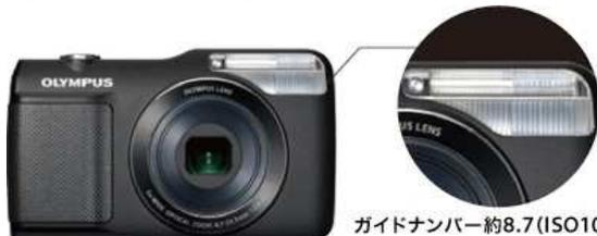
一般的なコンパクトデジタルカメラのガイドナンバー「4~5.6」に比べて、VG-170ではガイドナンバー約8.7(ISO100時)の大光量フラッシュを搭載。
