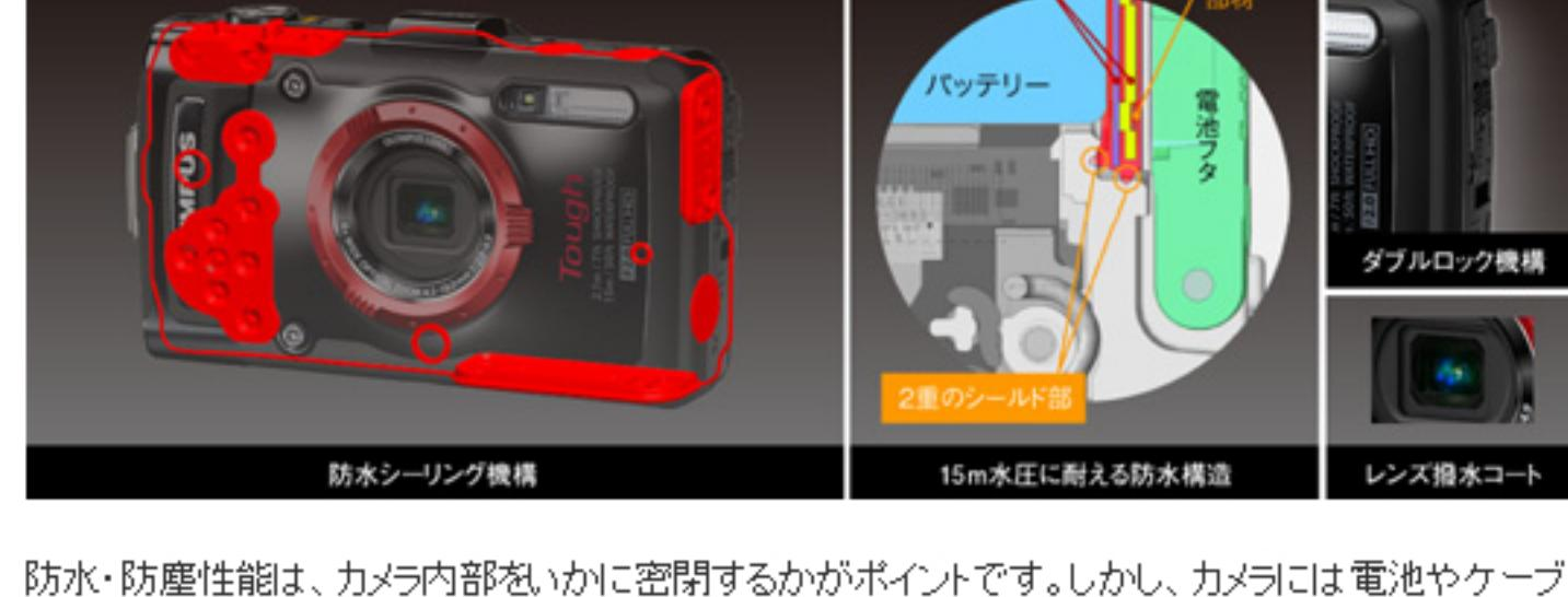
防水・防塵性能は、カメラ内部をいかに密閉するかがポイントです。しかし、カメラには電池やケーブルを接続するための端子があります。これらをキメ細やかに塞ぐためのオリンパス独自のノウハウが詰まっています。
